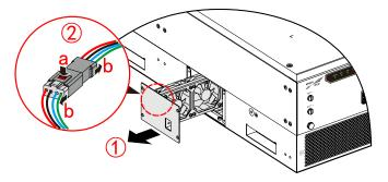
Figure 6-2 loosen the wiring of fan module
