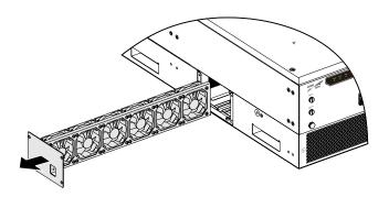
Figure 6-3 Pull out fan module
